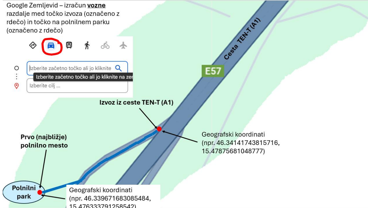
Slika1: Shematski prikaz načina izračuna oddaljenosti polnilnega parka od najbližjega izvoza s ceste TEN-T (npr. cesta A1)
